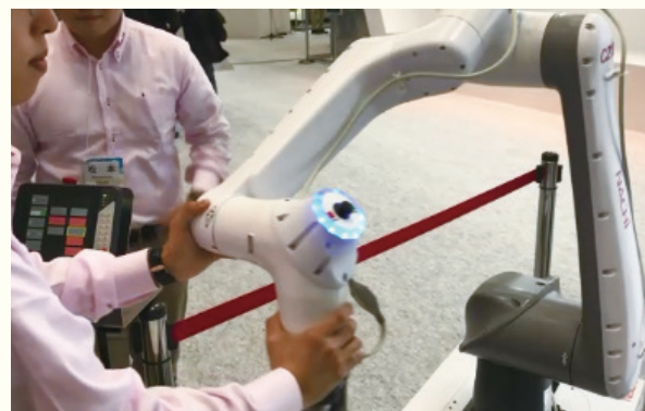
CZ-10へのダイレクトティーチング
